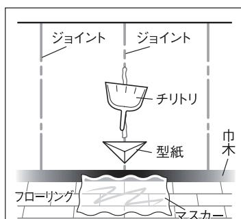
ジョイントの隙の下部に、チリトリ或は型紙等を利用した粉受けを当て養生するか、床にマスカー等を用いて粉をフローリングの上に落とさないよう養生をする。
